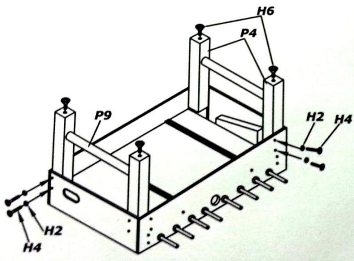
4. Pomocí křížových výztuh P9 připevněte nohy P4 k bočnicím P1 a zadní části P2 pomocí šroubů H4 a podložek H2. Do konce nohou P4 všroubujte koncovky H6, díky kterým budete moci stůl vyrovnat i na nerovném povrchu.
