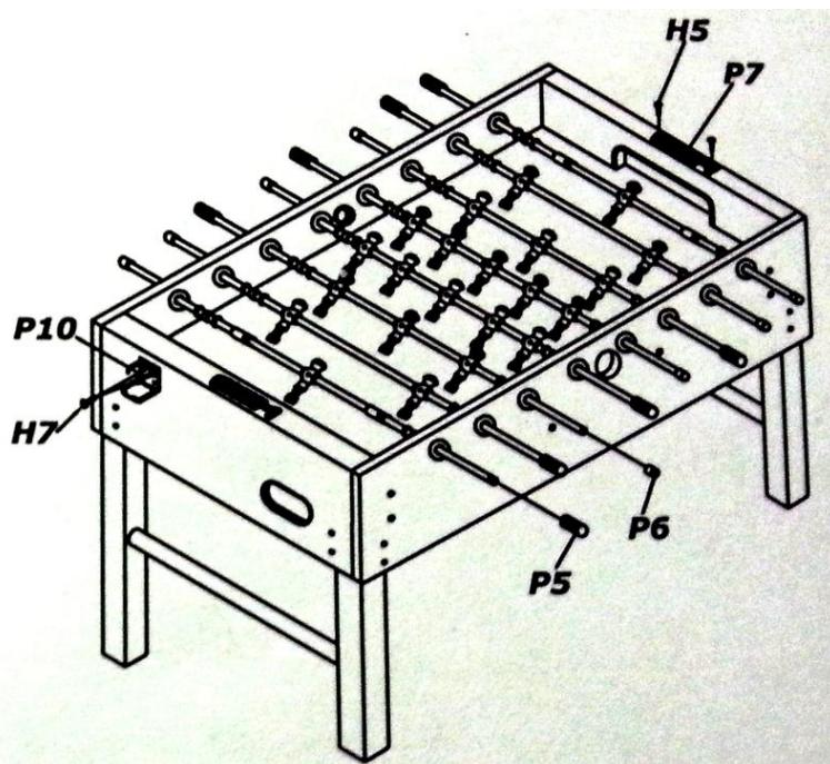
5. Pro tento krok jsou potřebné minimálně 2 dospělé osoby! Opatrně zvedněte stůl – pozor, stůl je těžký – a opatrně ho otočte deskou nahoru. Umístěte počítadla P7 pomocí šroubů H5 na oba konce stolu. Pomocí kruhových šroubů H7 umístěte na boky stolu držáky na nápoje P10. Na tyče umístěte madla P5 a na druhou stranu tyče umístěte ochranný díl P6. (Madla se na tyče umísťují lépe, když na tyč kápnete trochu mýdla.)
