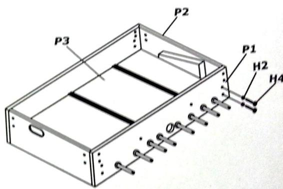
3. Koncové části P2 připojte na bočnice P1 za pomoci šroubů H4 a podložky H2. Zkontrolujte, že stěny svírají pravý úhel!
